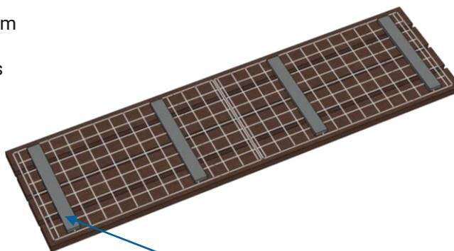
Planches d'assemblage 2x6 cm maintenant les planches d'assise au gabion
