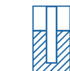
Poteaux rallongés pour scellement
